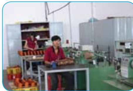
Hệ thống cuốn dây đếm số vòng tự động
