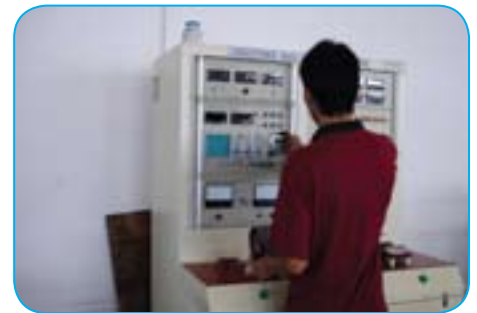
Hệ thống kiểm tra rò rỉ điện cách điện
